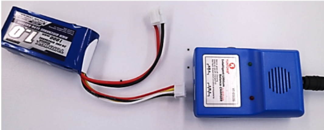
バッテリーと充電器の接続
